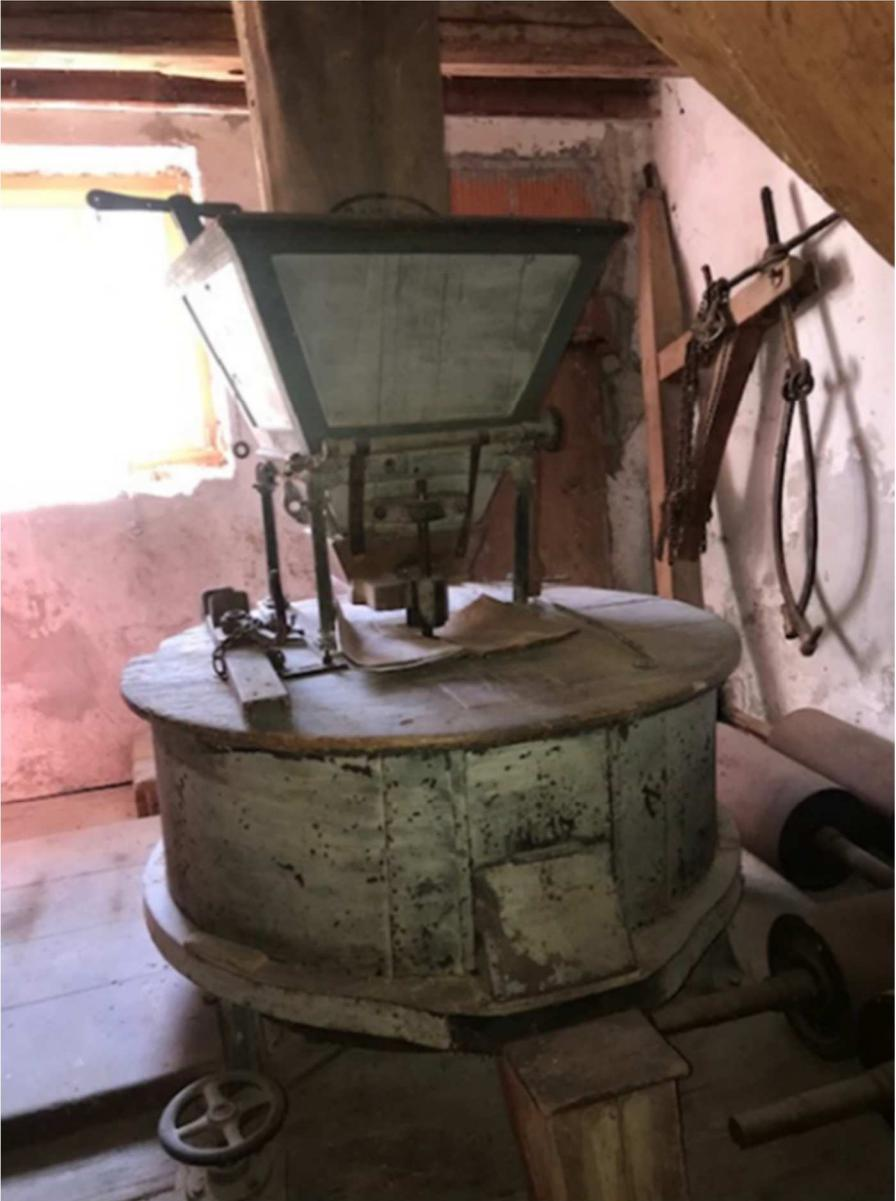
*Bild 18: Mahlgang in der Sauter-Mühle*
