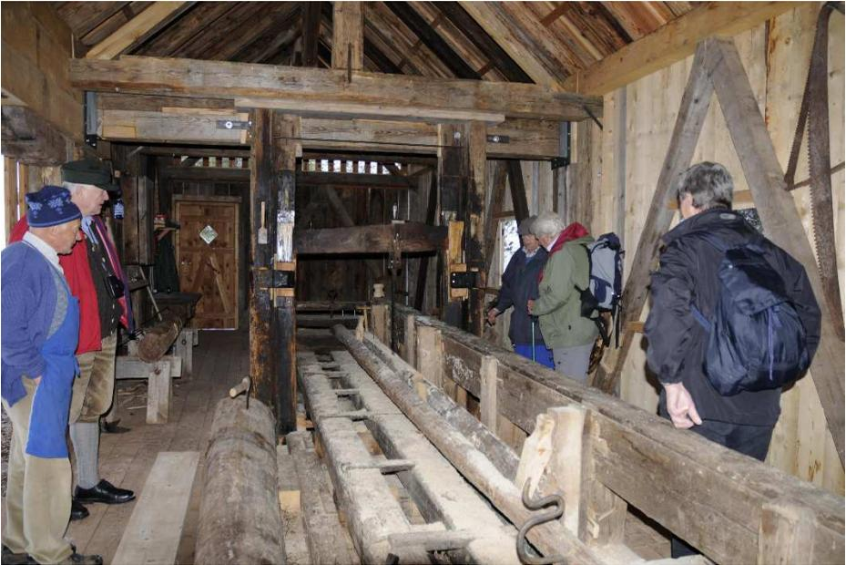
*Bild 22: Nahezu baugleich ist das Gatter in einer kombinierten Getreide- und Sägemühle zwischen Melle und Osnabrück. Es wurde 1836 eingebaut. Das Gatter wird noch heute von einem überschlächtigen Wasserrad angetrieben, hilfsweise durch einen Elektromotor. Die Säge wurde von einem Verein, der sich in der Jugendarbeit engagiert, in enger Abstimmung mit dem Eigentümer restauriert.*
