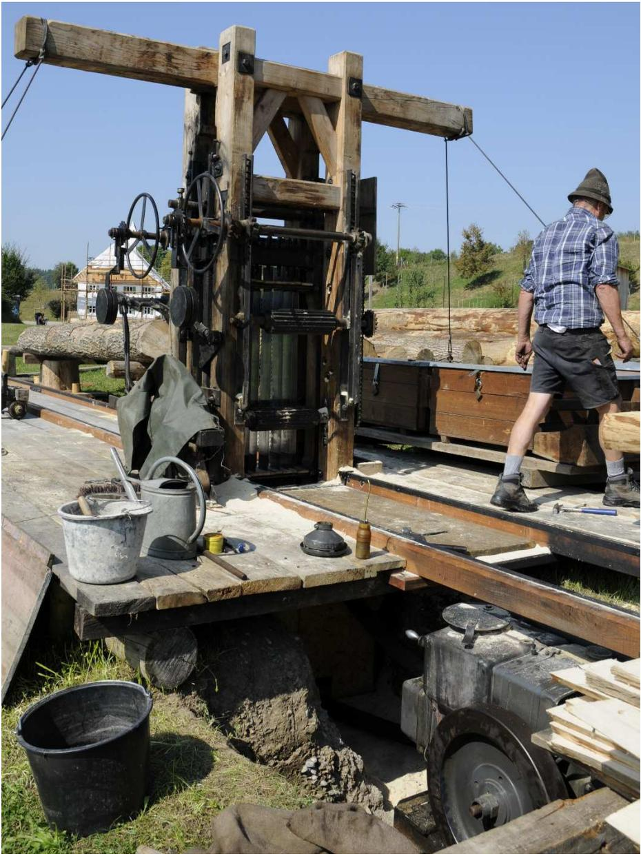
*Bild 32: Zu Demonstrationszwecken wurde im Jahr 2010 anlässlich eines Aktionstages im Freilichtmuseum Illerbeuren ein mobiles Sägewerk aufgebaut, das sein Besitzer ansonsten bei Allgäuer Waldbauern installiert. Für den Aufbau des mobilen Sägewerks benötigt der Besitzer rund zwei Tage. Am aufwendigsten ist dabei der Aushub einer tiefen Grube für den Gatterrahmen, der im absoluten Lot stehen muß.*
