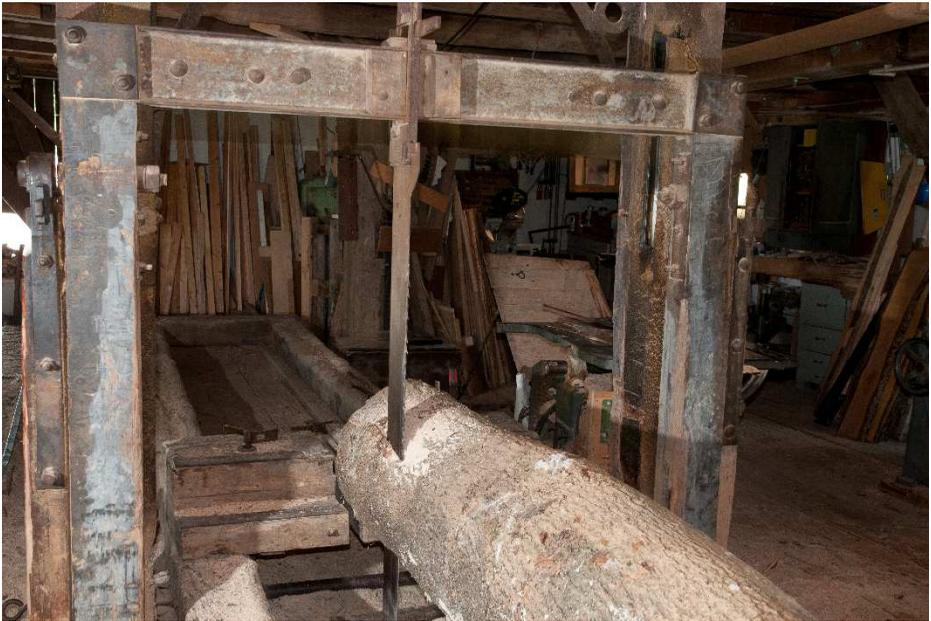
*Bild 21: Das Hochganggatter in der Furthmühle bei Egenhofen stammt wohl aus dem Erbauungsjahr 1828 und wurde in den nachfolgenden Jahrzehnten immer wieder verändert und dem jeweiligen technischen Standard angepasst. Die Gatterkonstruktion folgt dem Prinzip der sogenannten Augsburgur Säge.*
