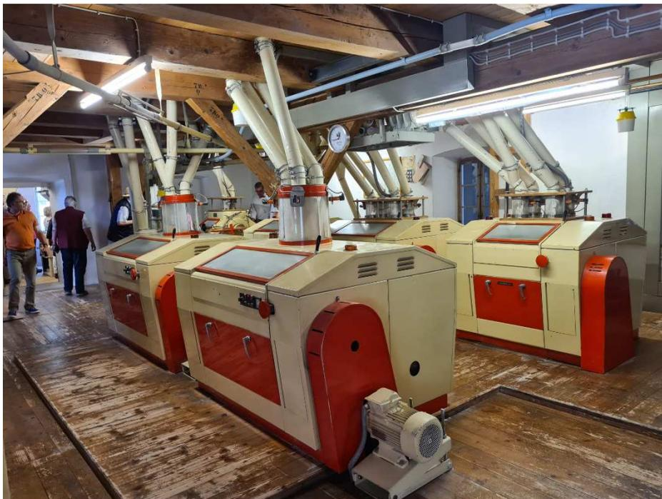
Abbildung 7: Der Walzenboden der Leitzachmühle
